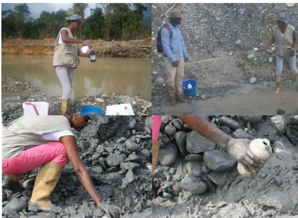
Figura 1. Toma de muestras y medición de caudal de vertimientos mineros
